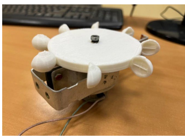
Рисунок 4.5 – Крепление рабочего колеса гидротурбины на двигатель
