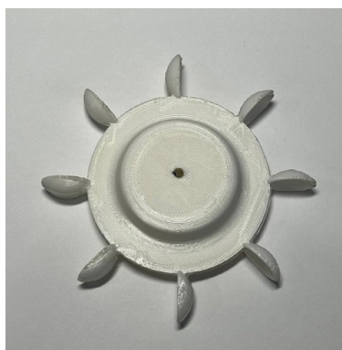
Рисунок 4.3 – Модель рабочего колеса гидротурбины, распечатанная на 3D принтере
