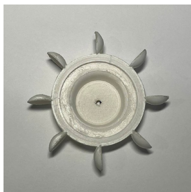
Рисунок 4.3 – Модель рабочего колеса гидротурбины, распечатанная на 3D принтере
