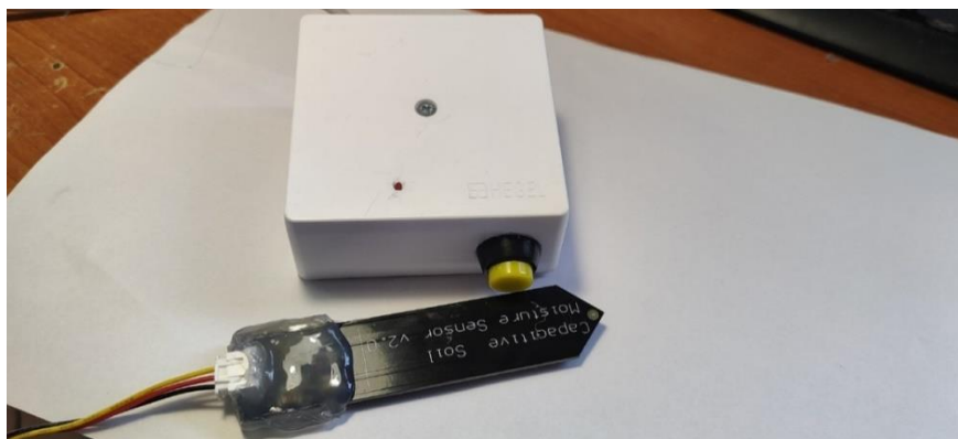
Рисунок 5. Портативная бытовая метеостанция на базе микроконтроллера ESP8266-12
